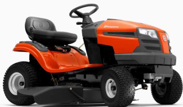
El tractor cortacésped de Husqvarna TS 138L es muy sencillo de manejar. Se ha desarrollado para los propietarios de jardines pequeños o de tamaño medio. Eficiente, con descarga lateral, diseño inteligente y gran ergonomía. El TS 138L está equipado con un potente motor con arranque sin estrangulamiento, transmisión hidrostática accionada por pedal y volante ergonómico.
