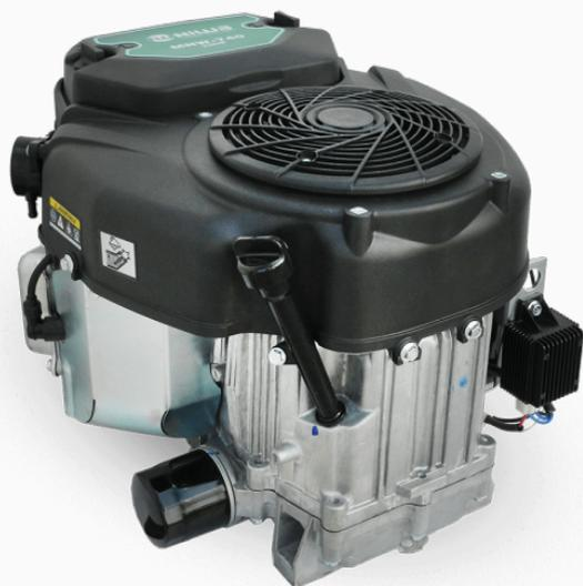
El modelo MVNW-740 pertenece a la línea de motores verticales nafteros, bicilíndricos, 4 tiempos, con arranque eléctrico, de la marca Niwa. Se destaca por su robustez y potenciación en tractores cortacésped de gran producción. Sus características: 23 HP / 740 CC y válvulas a la cabeza (OVH). Apto para 54" / 137 cm de corte. Ideal para motorizar minitractores corta de césped y Radio ceros. Mantenimiento de jardines amplios, municipios, clubes de campo, estancias, countries, etc.
