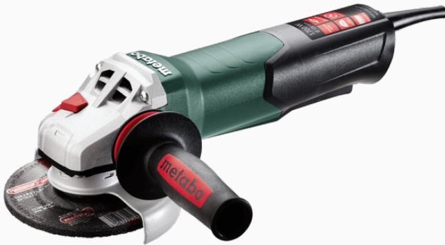
Amoladora de 1700 W para uso industrial con disco de 125 mm, con sistema quick para cambio rápido de disco y guarda ajustable sin necesidad de herramienta. Por su bajo peso y su gran potencia se recomienda para trabajo sobre cabeza. Su Motor Marathon brinda mayor potencia con un torque elevado y un 20 % mas de vida útil. con embrague mecánico, arranque suave, gatillo tipo paleta, seguro contra arranque involuntario, y sistema TC que mantiene las revoluciones constantes cuando aumenta la carga.
