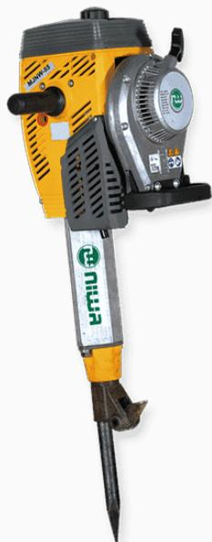
El motomartillo Niwa de 2 tiempos y 55 J de potencia, es la solución que independiza al operario de la unidad de potencia (electricidad /compresor). Para llevar a cualquier obra en cualquier parte.
