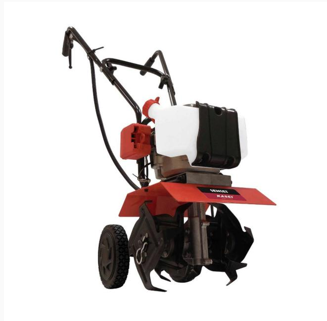
Motocultivador marca sensei modelo TC-430. Motor: 2T monocilindrico de 42,7 cc, refrigerado por aire (filtro de goma espuma). Potencia maxima: 1,2 kW/ 7000 rpm. Arranque: Manual con polea retractil. Transmision: Embrague centrifugo y caja de engranajes. Ancho de trabajo 24 cm - Prof. de trabajo 100 mm - Peso: 15 kg.
