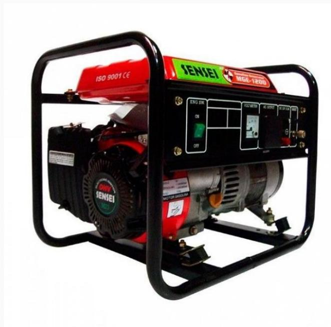
1050 watts - Con regulador de voltaje: condensador Con tomacorrientes monofásicos construidos conforme a norma IRAM - 2071 con tapa abatible. Alternador sin escobillas, autoexcitable, de dos polos y fase simple. Regulación de voltaje por condensador. Sensor de aceite. Panel de control completo con llave térmica, voltímetro y salida de 12V / 8,3 A. Silenciador de escape grande para reducir ruidos. Tanque de grandes dimensiones para mayor autonomía.
