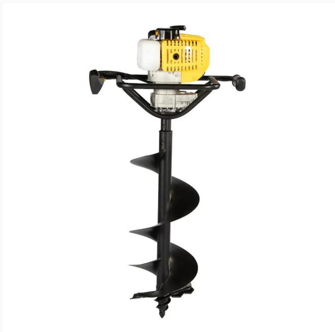
Hoyadora con mecha de 250mm (Opcional mecha de 150 y 200 mm, para suelos con falta de humedad) Importante: en el caso de suelos duros o de baja humedad, es necesario utilizar la broca de Ø150 , esta es un opcional que se vende por separado de la hoyadora. La hoyadora viene con una broca de Ø250 mm.
