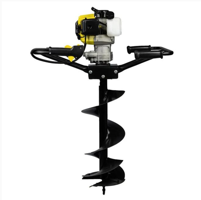
Hoyadora con mecha de 300mm (Opcional mecha de 150 y 200 mm, para suelos con falta de humedad) Hoyadora para 2 Personas con mecha de 300 MM. MOTOR 51,6 CC. 2 TIEMPOS / 2 HP / PESO: 9,2 / Tanque: 1 Litro. Importante: en el caso de suelos duros o de baja humedad, es necesario utilizar la broca de Ø150 mm. , esta es un opcional que se vende por separado de la hoyadora. La hoyadora viene con una broca de Ø300 mm.
