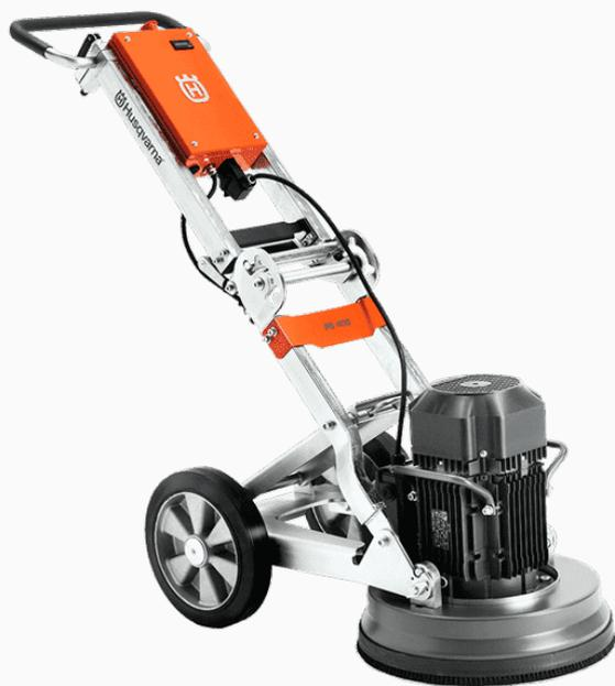
La PG400 es una productiva pulidora trifásica de 400 mm de diámetro para preparación y limpieza de superficies con segmentos diamantados. Remueve rápidamente endurecedores, epoxi y pinturas. Logra acabados perfectos (planos y lisos). Adecuada para superficies de 250 - 500 m<sup>2</sup>. Ajustable para facilitar una posición ergonómica de trabajo, desarmable y plegable para facilitar el transporte e instalación. Para un resultado óptimo se recomienda el uso con la aspiradora Husqvarna DC 3000.
