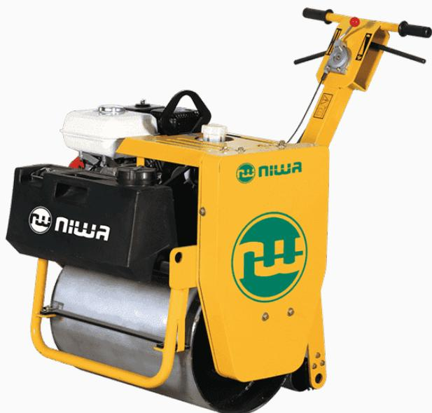
Este rodillo vibratorio de 266 kg de peso con tanque de agua, tiene un motor de 6,5 HP y avance hidráulico (el operador camina detrás). Especifico para suelos y pavimentos (tiene tanque de agua), puede trabajar en pendientes de hasta 30% y en zanjas de de 0,70 m de ancho
