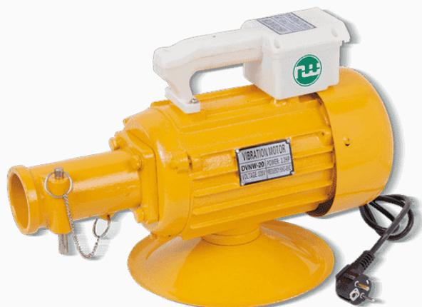
El motor eléctrico mas utilizado para vibradores de inmersión. Este motor de 2,0 HP y 3000 RPM, es ideal para cabezales de vibrador de 38 / 45 / 50 / 70 mm de diámetro, así como para bombas sumergibles Niwa. Con conector Dynapac. Monofásico.
