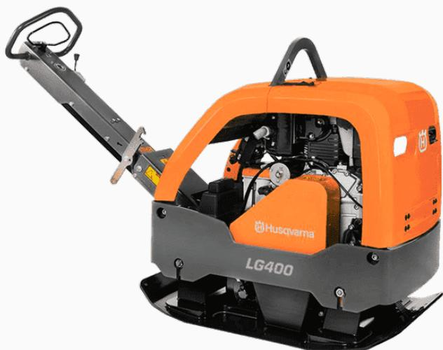
La LG 400 es una imponente plancha compactadora reversible de 398 kg, potente y fiable, que se ha desarrollado para ofrecer una compactación eficaz en suelos granulares de espesor intermedio a alto. Es una máquina eficaz que sirve como alternativa o complemento de los rodillos en trabajos de compactación en espacios reducidos, con un rendimiento de 975 m<sup>2</sup>/hora. Cuenta con un diseño ergonómico y fácil de mantener.
