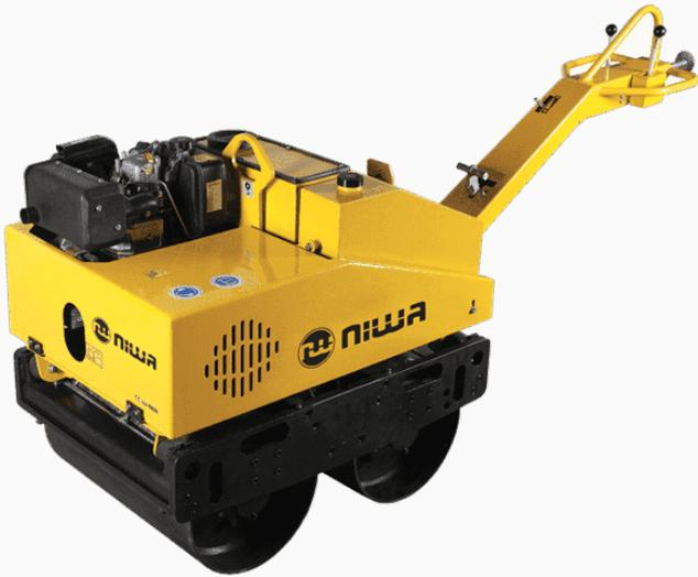
RODILLO COMPACTADOR NIWA ROLNW-643, un rodillo vibratorio DOBLE de 580 kg de peso y motor de 13.0 HP Niwa, para compactar suelo y concreto asfáltico. Los dos rodillos traccionan, los dos rodillos vibran. Un concepto económico y práctico, con arranque eléctrico, fácil de operar y de muy eficiente compactación. Trabaja en pendientes de hasta 30%. Además, posee un sistema de amortiguación de las vibraciones que aísla al operario de las mismas, para que la condición de trabajo sea la adecuada.
