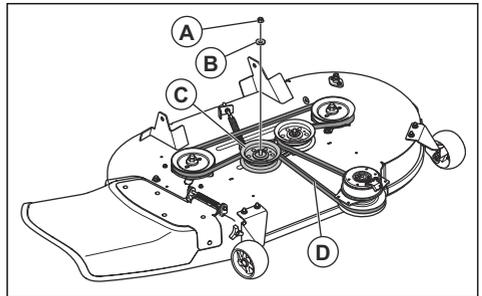
6. Retire la correa del equipo de corte (D) de las poleas de las cuchillas del equipo de corte.
