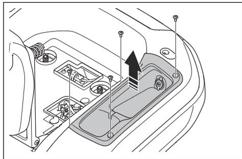
3. Retire la cubierta del terminal del cable negro de la batería.
