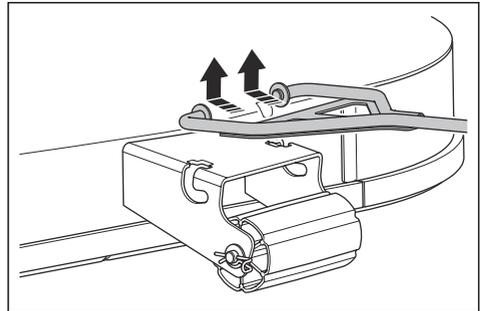
7. Coloque la palanca de altura de corte en la posición más alta.
