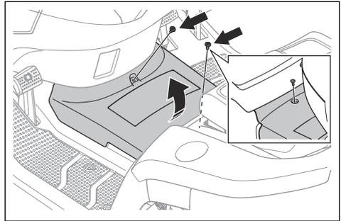
2. Levante con cuidado el extremo trasero de la cubierta del túnel del bastidor y retírela.
