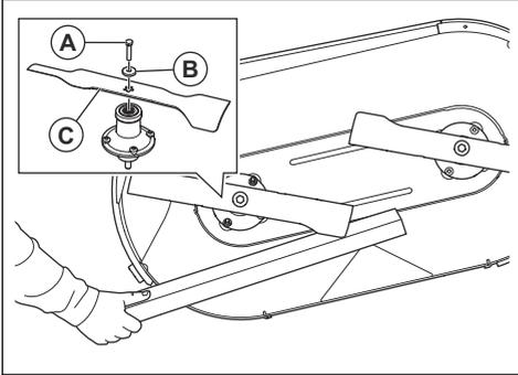
3. Retire el tornillo (A), la arandela (B) y la cuchilla (C).
