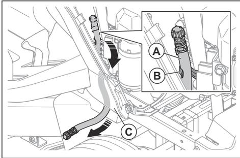
2. Coloque un recipiente debajo del tapón de vaciado del aceite.
