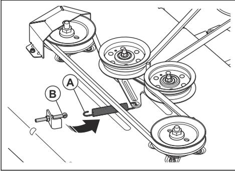
4. Retire la correa del equipo de corte de la polea del motor.
