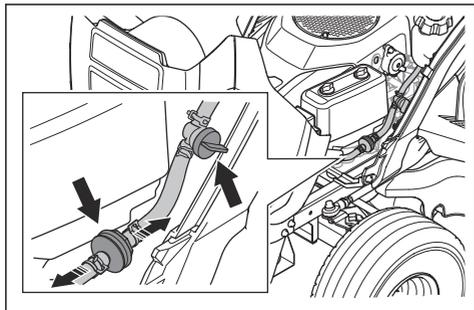
6. Instale el nuevo filtro de combustible en los extremos de las mangueras. Aplique líquido detergente a los extremos del filtro de combustible para facilitar la conexión.
