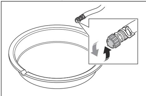
5. Una vez que haya vaciado todo el aceite, instale el tapón en la válvula de drenaje de aceite.
