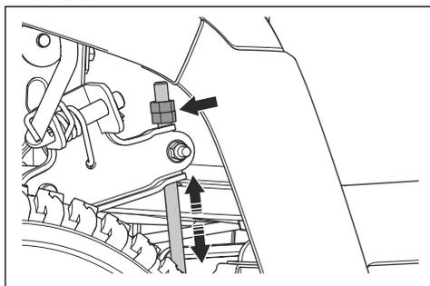
**Nota:** Los tirantes de la altura de corte se encuentran detrás del equipo de corte, delante de las ruedas traseras.
