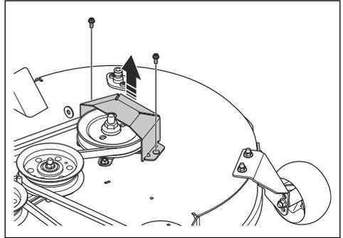
4. Retire la suciedad y la hierba de alrededor de las carcasas de los cojinetes, de las poleas de las cuchillas y de la parte superior del equipo de corte.
