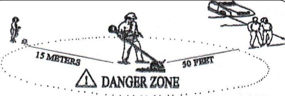
Solo el operador de la maquina debe permanecer en la zona de peligro, de 15 metros de radio. Debe utilizar protección para la vista, los oídos, el rostro, los pies y el cuerpo. Toda persona en la zona de peligro o de riesgo (mas allá de la zona de peligro) Debe usar protección para la vista por los objetos que la maquina puede arrojar. El riesgo disminuye a medida que se alejan de la zona de peligro.
