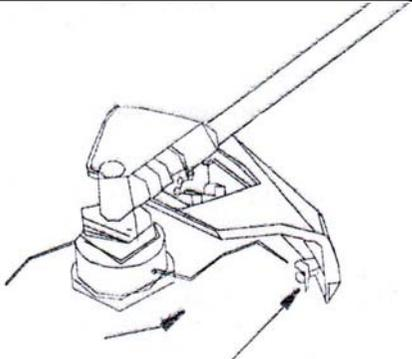
Cuchilla del lado izquierdo. El cabezal gira en sentido antihorario. La cuchilla queda del lado izquierdo de la protección
