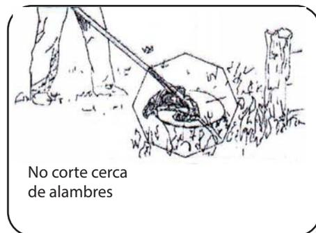
Para cortar un borde, incline lentamente el cabezal para que los desechos salgan despedidos en dirección contraria a usted. Si va a cortar hasta una determinada superficie, como un cerco, una pared o un árbol, acerque la máquina de modo tal que los desechos que reboten no vayan hacia usted.
