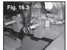
*Notar que las fajas se han removido, es fácil verificar la distancia entre las cuchillas y la contra cuchilla, porque el rotor puede girar libremente.*
