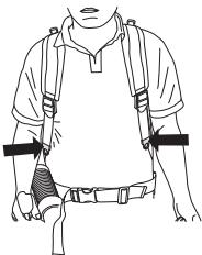
Coloque la cinta de cadera sobre la cadera, no demasiado baja en el abdomen. Apriete la cinta de cadera hasta que note que el peso del soplador descansa en la cadera.
