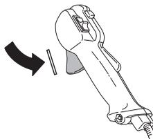
Apriete el fiador del acelerador y compruebe que vuelva a su posición de partida al soltarlo.
