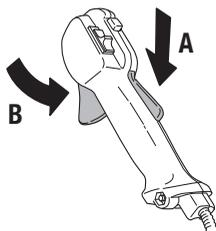
Compruebe que el acelerador esté bloqueado en la posición de ralentí cuando el fiador está en su posición inicial.
