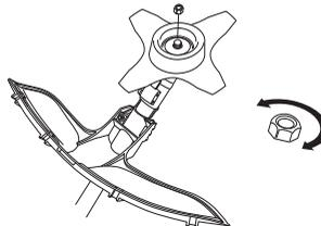
Para el montaje, apriete la tuerca girándola en sentido contrario al sentido de rotación del equipo de corte. Para el desmontaje, afloje la tuerca girándola en el sentido de rotación del equipo de corte. (NOTA: La tuerca tiene
