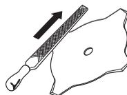
Revise el equipo de corte para ver si está dañado o agrietado. Un equipo de corte dañado debe ser siempre reemplazado.
