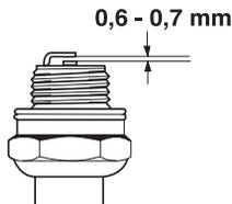
**¡NOTA!** ¡Utilice siempre el tipo de bujía recomendado! Una bujía incorrecta puede arruinar el pistón y el cilindro. Asegúrese de que la bujía tenga supresión de perturbaciones radioeléctricas.
