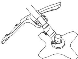
Controle que la protección no esté dañada y que no tenga grietas. Cambie la protección si ha estado expuesta a golpes o si tiene grietas.
