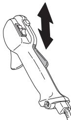
Compruebe que el acelerador y el fiador se muevan con facilidad y que funcionen sus muelles de retorno.
