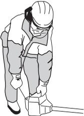
**¡NOTA!** No poner ninguna parte del cuerpo en la superficie marcada. El contacto puede causar quemaduras en la piel o sacudidas eléctricas si el excitador de ignición es defectuoso. Utilice siempre
