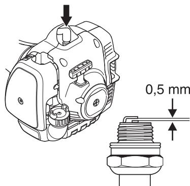
**¡NOTA!** ¡Utilice siempre el tipo de bujía recomendado! Una bujía incorrecta puede arruinar el pistón y el cilindro. Asegúrese de que la bujía tenga supresión de perturbaciones radioeléctricas. Póngase en contacto con su concesionario o con Husqvarna si necesita más información.
