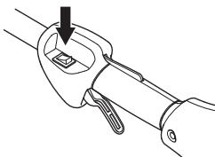
**REMARQUE!** L'interrupteur d'arrêt se remet automatiquement en position de démarrage. Toujours retirer le chapeau de bougie de la bougie lors du montage, contrôle et/ou entretien, afin d'éviter tout démarrage accidentel.
