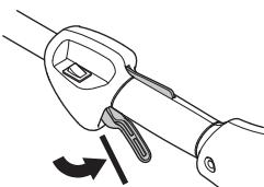
Apriete el fiador del acelerador y compruebe que vuelva a su posición de partida al soltarlo.
