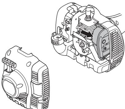
Le risque d'incendie est important dans les pays au climat chaud et sec. C'est pourquoi nous avons équipé certains silencieux de grilles antiflamme. Vérifier si le silencieux de la machine est muni d'un tel dispositif.
