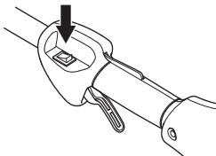
**¡NOTA!** El contacto de parada retorna automáticamente a la posición de arranque. Por consiguiente, antes de realizar trabajos de montaje, control y/o mantenimiento se debe quitar el capuchón de encendido de la bujía para evitar el arranque imprevisto.
