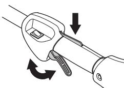
Voir le chapitre Démarrage. Démarrer la machine et donner les pleins gaz. Relâcher l'accélérateur et s'assurer que l'équipement de coupe s'arrête et qu'il reste immobile. Si l'équipement de coupe tourne lorsque l'accélérateur est au régime de ralenti, contrôler le réglage du ralenti du carburateur. Voir le chapitre Entretien.
