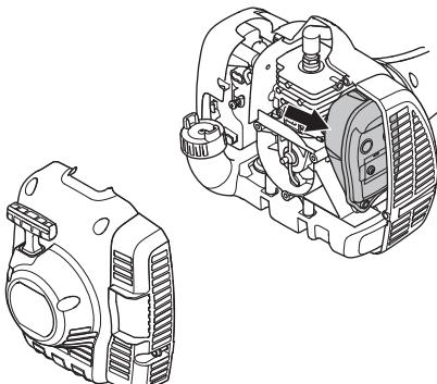
En países con clima cálido y seco, puede ser grande el riesgo de incendio. Por eso, hemos equipado ciertos silenciadores con cortafuegos. Controle si el silenciador de su máquina lo tiene.
