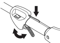
Consulte las instrucciones bajo el título Arranque. Ponga en marcha la máquina y acelere al máximo. Suelte el acelerador y controle que el equipo de corte se detenga y permanezca inmóvil. Si el equipo de corte gira con el acelerador en ralentí, se debe controlar la regulación del carburador para ralentí. Consulte las instrucciones bajo el título Mantenimiento.
