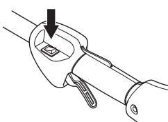
Mettre le moteur en marche et s'assurer qu'il s'arrête lorsque le bouton d'arrêt est amené en position d'arrêt.
