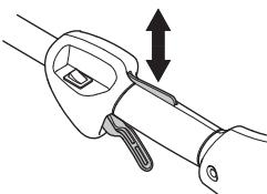
Compruebe que el acelerador y el fiador se muevan con facilidad y que funcionen sus muelles de retorno.
