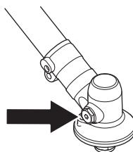
Generalmente, el lubricante en el cuerpo del engranaje no requiere cambiarse excepto cuando se realizan reparaciones.
