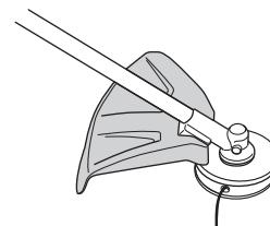
Controle que la protección no esté dañada y que no tenga grietas. Cambie la protección si ha estado expuesta a golpes o si tiene grietas.
