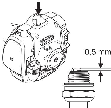
**REMARQUE!** Toujours utiliser le type de bougie recommandé! Une bougie incorrecte peut endommager le piston/le cylindre. S'assurer que la bougie est dotée d'un antiparasites. Contactez votre revendeur Husqvarna pour obtenir de plus amples informations.
