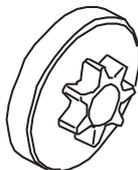
Compruebe regularmente el nivel de desgaste del piñón de arrastre de la cadena y cámbielo si presenta un desgaste anormal. El piñón de arrastre de la cadena debe cambiarse cada vez que se cambie la cadena.
