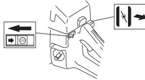
Si la máquina tiene una válvula de descompresión (A): oprima la válvula para reducir la presión en el cilindro y facilitar el arranque de la máquina. La válvula de descompresión debe utilizarse siempre para los arranques. Una vez que ha arrancado la máquina, la válvula vuelve automáticamente a la posición de partida.
