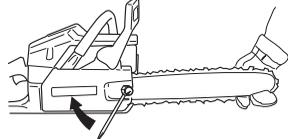
El tensado de una cadena nueva debe controlarse con frecuencia, hasta que se haya hecho el rodaje. Controle el tensado regularmente. Una cadena correcta significa buena capacidad de corte y larga duración.
