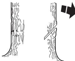
Luego, efectúe el corte inferior, que debe terminar exactamente donde terminó el corte superior.
