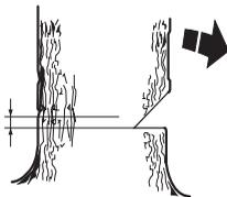
Coloque el apoyo de corteza (si ha sido montado) detrás de la faja de desgaje. Corte con aceleración máxima introduciendo lentamente la cadena/espada en el tronco. Preste atención a si el árbol se mueve en dirección opuesta a la elegida para el derribo. Tan pronto lo permita la profundidad de corte, ponga una cuña de derribo o una barra desgajadora en el corte de derribo.
