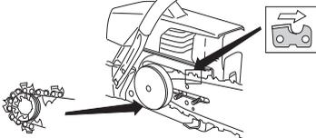
Monte la cubierta del embrague y ponga el vástago de tensado de cadena en el orificio de la espada. Compruebe que los eslabones de arrastre de la cadena encajen en el piñón de arrastre y que la cadena esté bien
