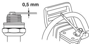
Aclaración! ¡Utilice siempre el tipo de bujía recomendado! Una bujía incorrecta puede arruinar el pistón y el cilindro. Asegúrese de que la bujía tenga supresión de perturbaciones radioeléctricas.
