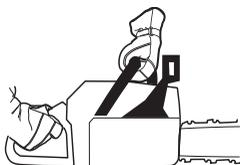
Acelere al máximo y active el freno de cadena girando la muñeca izquierda hacia la protección contra reculadas.
