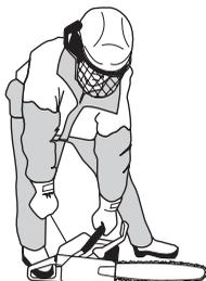
Dado que el freno de cadena todavía está activado, se deben bajar las revoluciones del motor lo antes posible a ralenti, y esto se logra desconectando rápidamente el fiador contra aceleraciones involuntarias. De ese modo, se evita un desgaste innecesario del embrague, del tambor del embrague y de la cinta de freno.
