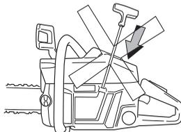
Para poner el freno de cadena en su posición inicial, mueva la protección contra reculadas hacia la empuñadura del mango. Ahora, la motosierra está lista para funcionar.
