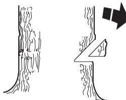
La profundidad del corte de indicación debe ser igual a 1/4 del diámetro del tronco, y el ángulo entre los cortes superior e inferior debe ser de 45° como mínimo.
