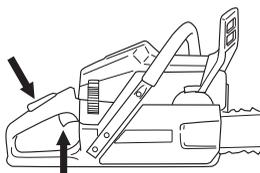
Cuando el motor encienda, oprima inmediatamente el estrangulador y repita los intentos de arranque hasta que el motor se ponga en marcha. Cuando arranque el motor, acelere al máximo y se desacoplará automáticamente la aceleración de arranque.
