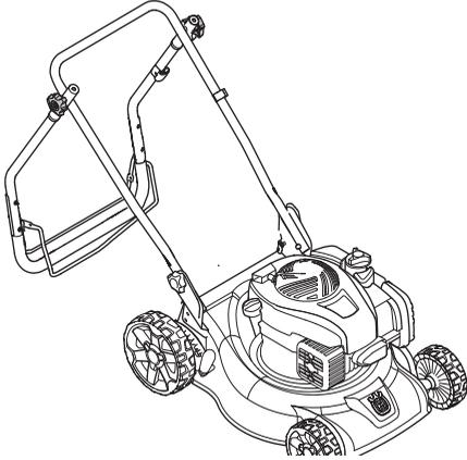
**¡NOTA!** La parte superior del manillar sólo se puede plegar hacia atrás. Si el manillar se pliega en la dirección incorrecta existe un mayor riesgo de dañar los cables.
