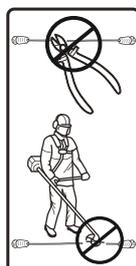
El cable de baja tensión no se debe acortar, alargar ni dividir.
