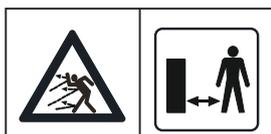
**ADVERTENCIA:** Mantenga una distancia de seguridad con respecto a la máquina cuando esté en funcionamiento. Mantenga alejados las manos y los pies de las cuchillas giratorias.
