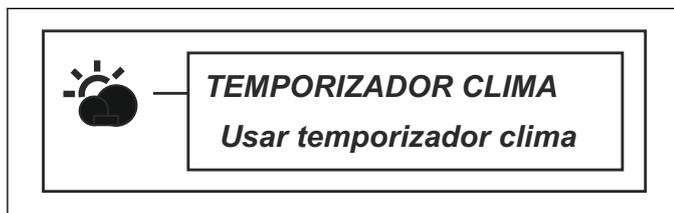
El temporizador clima permite al robot cortacésped ajustar automáticamente sus tiempos de corte en función de la velocidad de crecimiento del césped.
