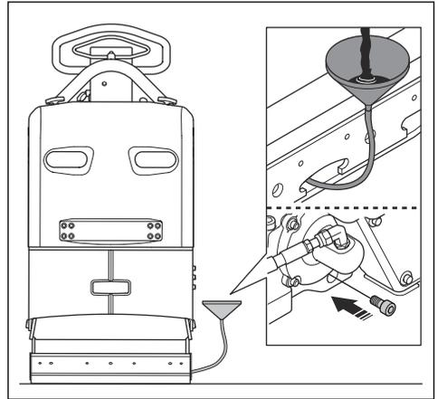
5. Instale el tapón de vaciado de aceite.
