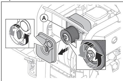
2. Gire la palomilla de bloqueo del filtro de aire hacia la izquierda y retire el filtro de aire (A) de su caja.
