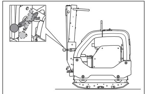
2. Use la argolla de elevación para sujetar el producto al equipo de elevación.
