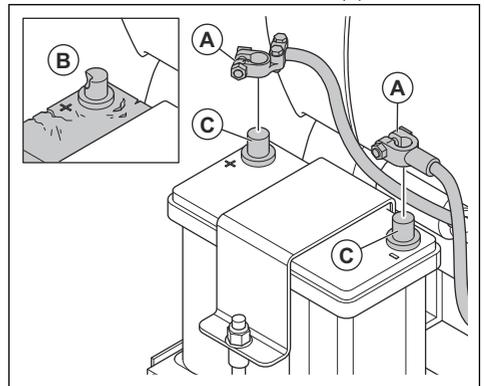
2. Examine la batería en busca de posibles daños (B). Sustituya la batería si está dañada.
