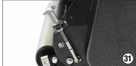
La altura de corte se ajusta girando el control de altura. La escala marcada proporciona una guía para la altura de corte establecida en milímetros. La altura de corte se ajusta moviendo la posición del rodillo en relación con la cuchilla inferior.
