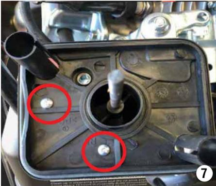
3. Retire 2 tornillos de la base del filtro de aire. Consulte las marcas en Fig. 7.
