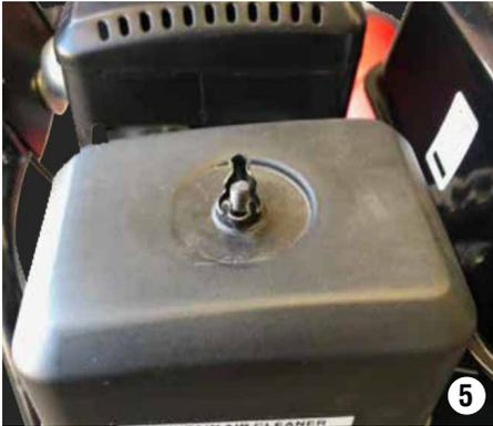
1. Retire la cubierta del filtro de aire (Fig. 5).
