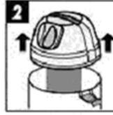
2. Coloque el filtro de espuma de plástico suministrado sobre la cesta del filtro (Figura 2) para la limpieza húmeda con aspiradora.
